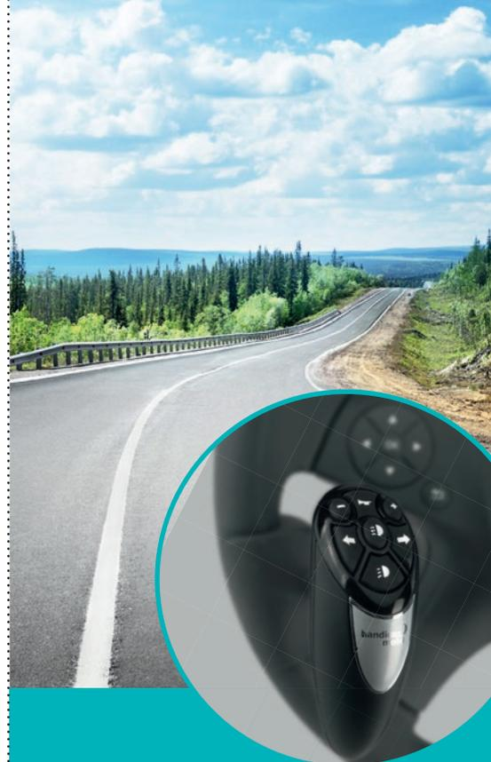
**LENKOK – der Lenkradkombinationsknopf ermöglicht die Bedienung der Funktionen Blinker, Wischer und Licht ohne Loslassen des Lenkrads.**
